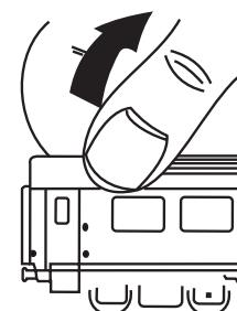
Durch kräftiges Zusammendrücken knapp über der Gehäusewand ist das Dach abzunehmen.
